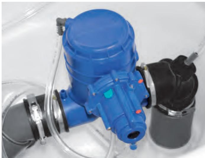
Die pneumatische Absaugventileinheit besteht aus dem eigentlichen Ventil und der zugehörigen Steuerung. Die Roediger® Membranventile zeichnen sich durch ihre Langlebigkeit, ihren universellen Einsatz und einfache Handhabung in Betrieb und Wartung aus. In Abhängigkeit der jeweiligen Anwendung kann zwischen verschiedenen Ventilgrößen (50 mm, 65 mm oder 75 mm Durchmesser) gewählt werden.
