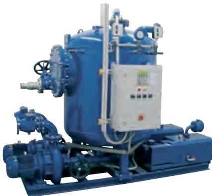
In der Roediger® Vakuumpumpe wird das Abwasser zunächst in einem Abwassertank gesammelt und dann mittels Abwasserpumpen zu einem konventionellen Hauptsammler oder direkt zu der Kläranlage gefördert. Der erforderliche Unterdruck im Leitungsnetz wird durch Vakuumpumpen in der Pumpstation erzeugt.
